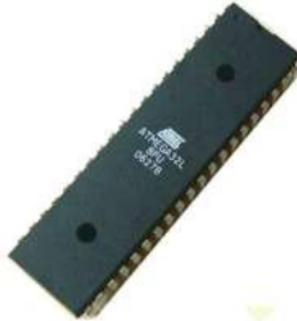
Gambar 1. Mikrokontroler ATmega 32
